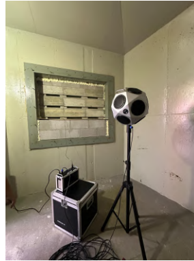
(c) Sistema montado na sala de emissão sonora.
