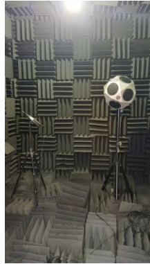
(b) Fonte sonora e sonômetro na sala de recepção.
